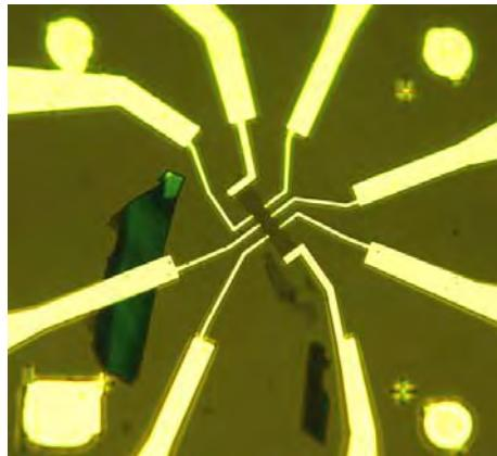
Slika 3: Grafenski device (Hall bar) dobiven eksfolijacijom grafena iz grafita na SiO podlogu i dodatnom litografskom obradom uzorka na Brookhaven laboratoriju u sklopu aktivnosti UKF projekta. Prikazana slika dobivena optičkim mikroskopom.
